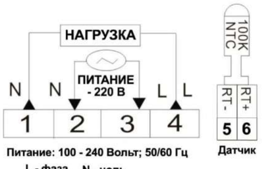
Схема 1. Схема подключения
