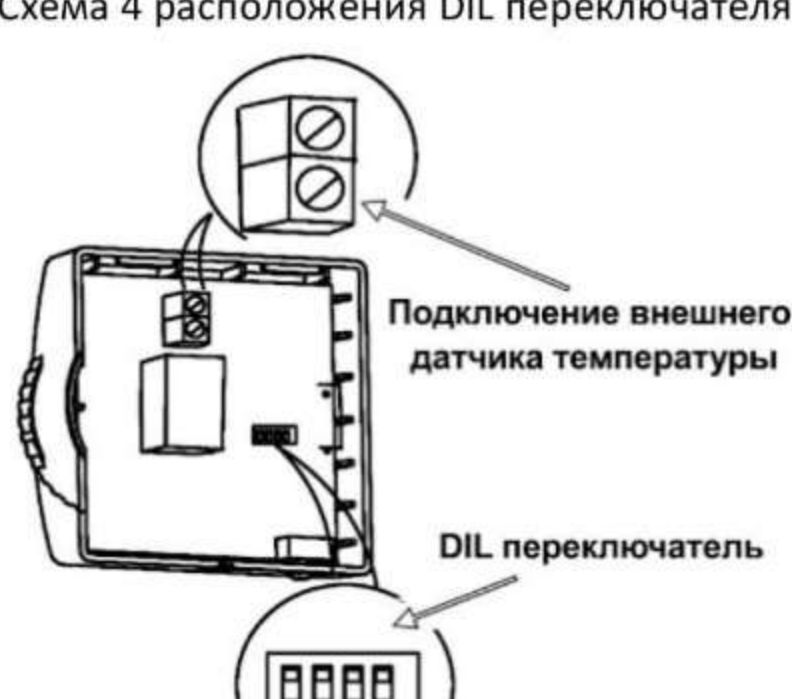
Схема 4 расположения DIL переключателя
