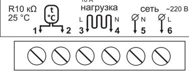
Схема 1. Схема подключения и упрощенная внутренняя схема
