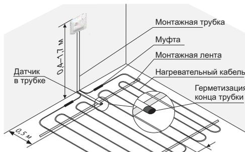
Рисунок 1. Монтаж терморегулятора и системы «теплый пол»
