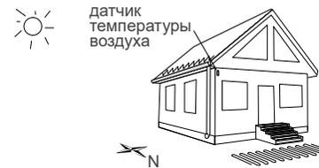
Рисунок 1. Монтаж датчика температуры воздуха
