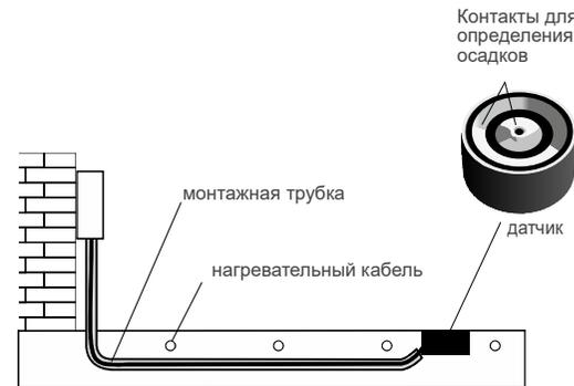
Рисунок 2. Способ монтажа датчика осадков при подогреве грунта.
