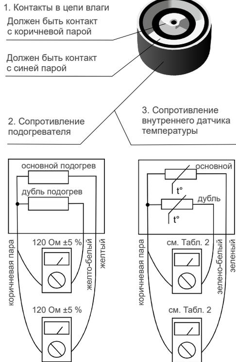
Рисунок 7. Устройство датчика осадков OSA
